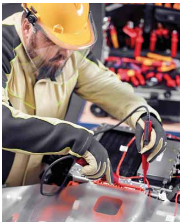
Abb. 10 Arbeiten an unter Spannung stehenden HV-Komponenten
