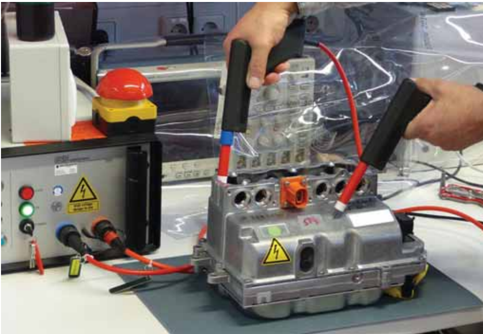
Abb. 11 Spannungsprüfung an einer HV-Komponente
