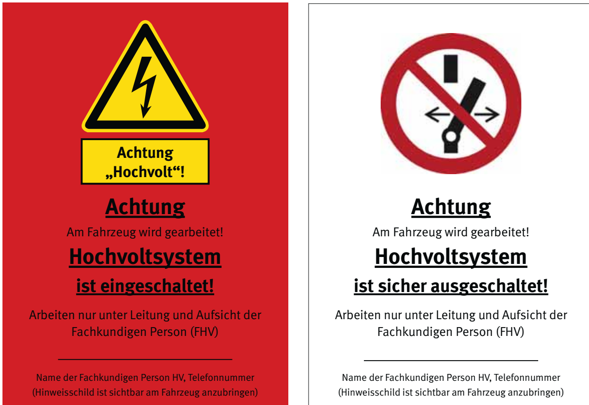
Abb. 7 Beispiele für die Kennzeichnung von HV-Fahrzeugen in der Werkstatt
