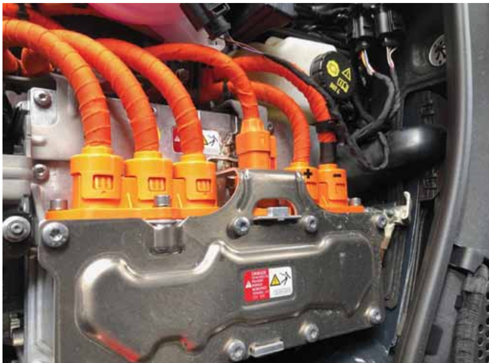
Abb. 2 Basisschutz durch Isolation und Abdeckung
