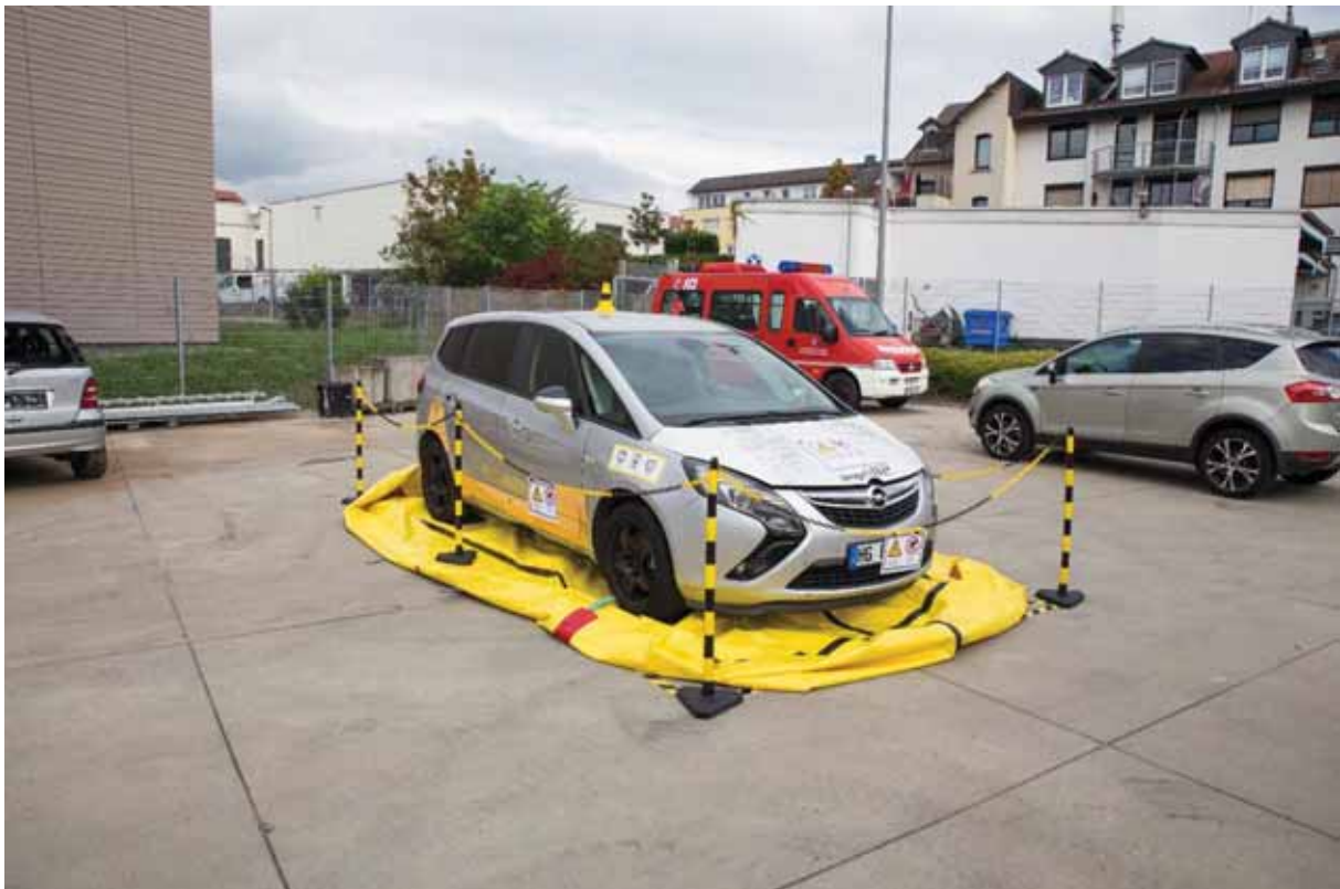
Beispiel für ein vorquarantänisiertes Fahrzeug mit mobilem Löschwasserrückhaltesystem
