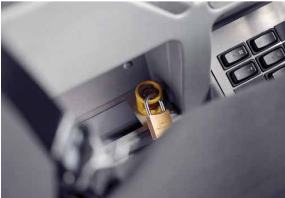
Abb. 4 Beispiel für das Sichern gegen Wiedereinschalten
